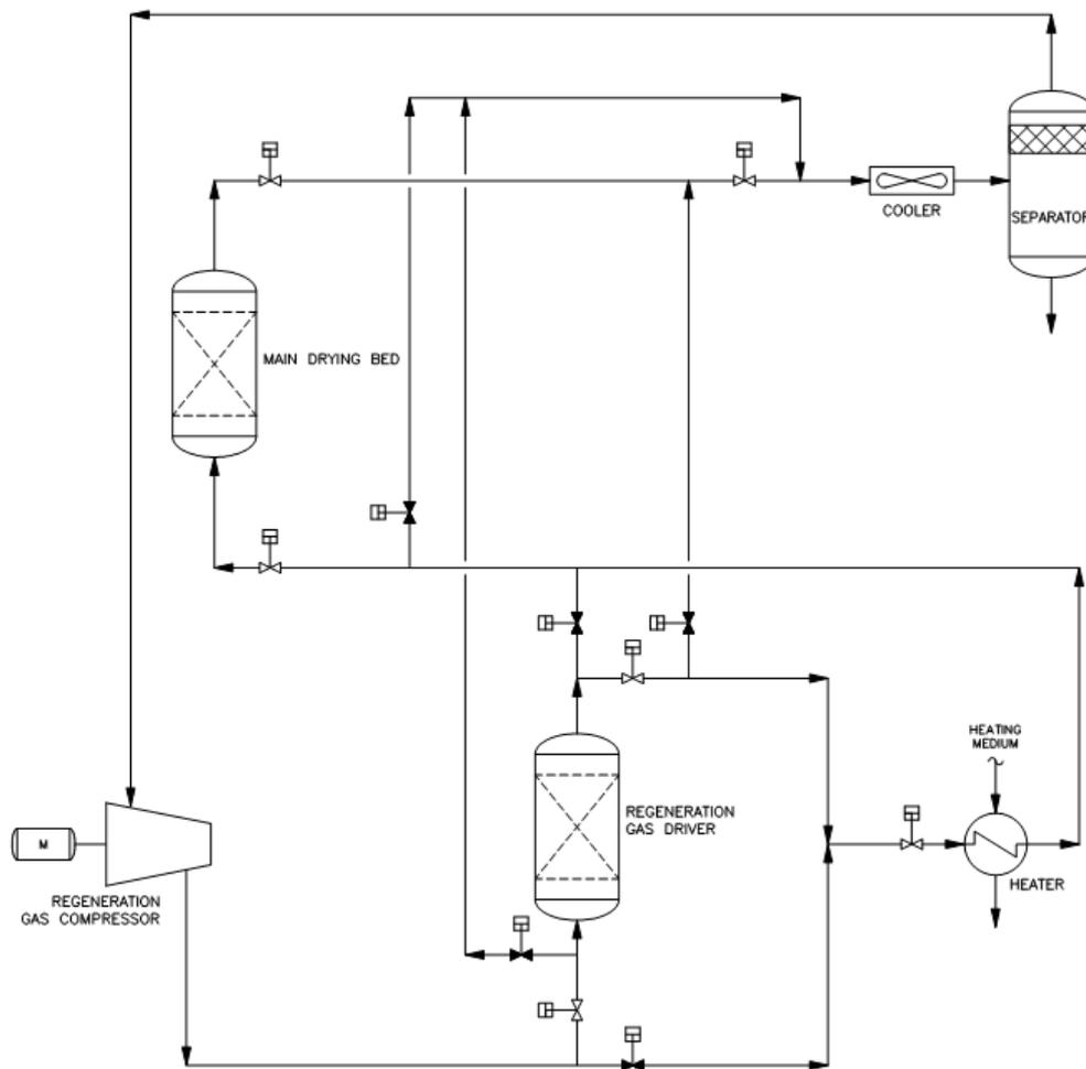
**Figure 2. Mole Sieve Dehydrator Regeneration Circuit**
